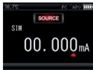
Рис. 23. Имитация выходного тока (пассивный режим)
