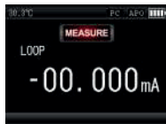
Рис. 11. Измерение токовой петли
