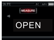
Рис. 15. Проверка целостности цепи
